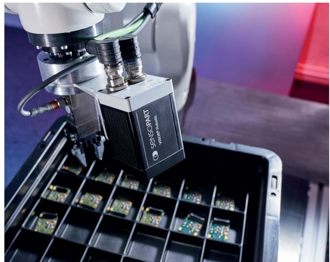
werden können. In bestimmten Anwendungen ist es daher auch denkbar, bis zu vier Vision-Sensoren mit normaler Auflösung durch einen Visor V50 zu ersetzen und dadurch Kosten zu sparen.
