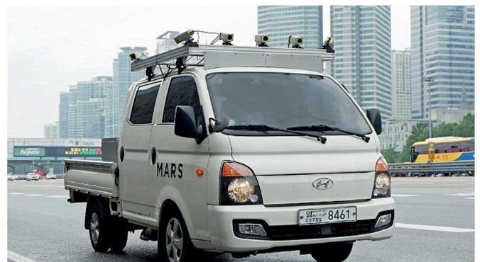
Probleme innerhalb von fünfeinhalb Stunden zurück. Zum Schutz der Dachkameras setzt Marsauto auf die Kameraschutzgehäuse der Salamander-Serie von autoVimation. Die extrem robusten Gehäuse mit zylindrischer Innenform und Schutzart IP 66/67 zeichnen sich durch kompakte Abmessungen mit geringem Eigengewicht und eine gute Wärmeableitung aus. Die Schutzgehäuse sind für Kamera-Querschnitte von 29 mm x 47 mm bis 40 mm x 40 mm ausgelegt und in vier Längen erhältlich.
