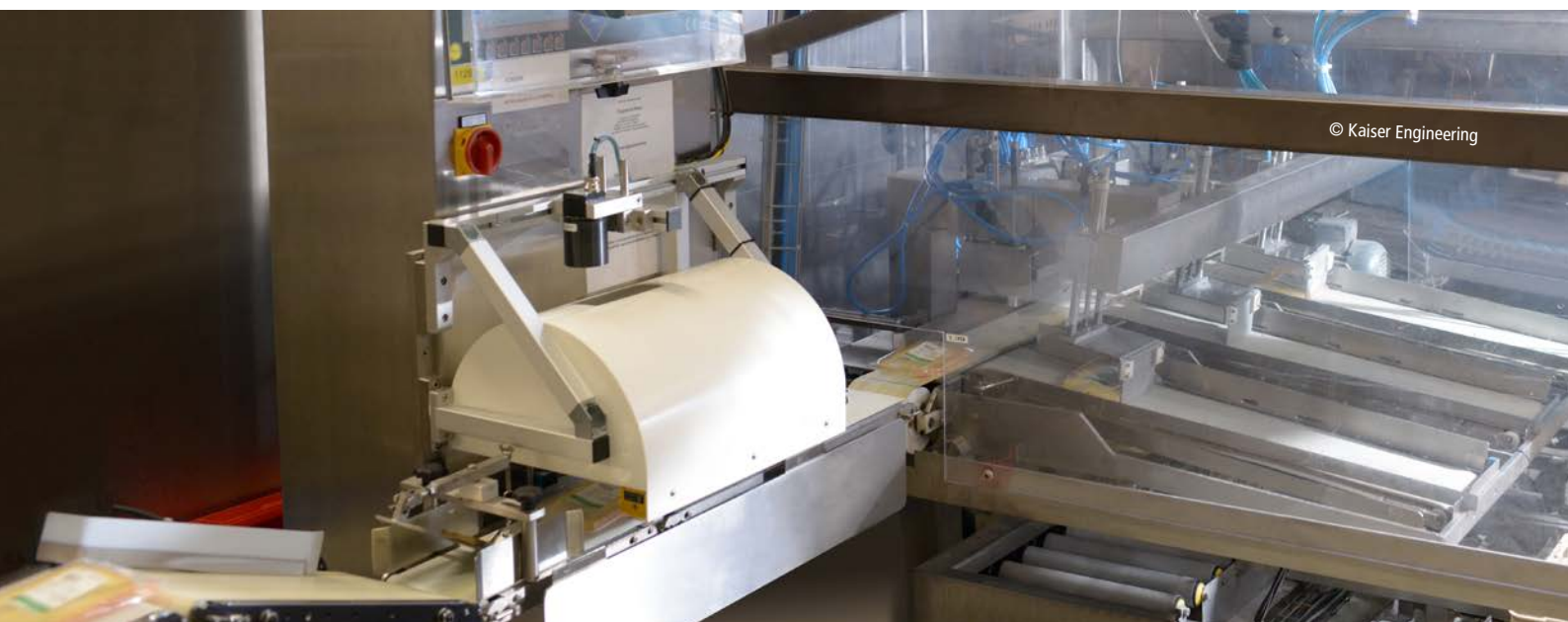
Abb. 1: Die Käseverpackungen laufen an dieser Station von links kommend unter dem Bildverarbeitungssystem hindurch und werden nach der Inspektion von einem Roboter in Transportkisten abgelegt.
